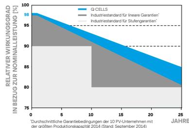
Mindestens 98% der Nennleistung innerhalb des ersten Jahres. Danach max. 0,54% Degradation pro Jahr. Mindestens 93,1% der Nennleistung nach 10 Jahren. Mindestens 85% der Nennleistung nach 25 Jahren. Alle Daten innerhalb der Messtoleranzen. Volle Produkt- und Leistungsgarantien entsprechend der jeweils gültigen Garantien der Q CELLS Vertriebsgesellschaft Ihres Landes.
